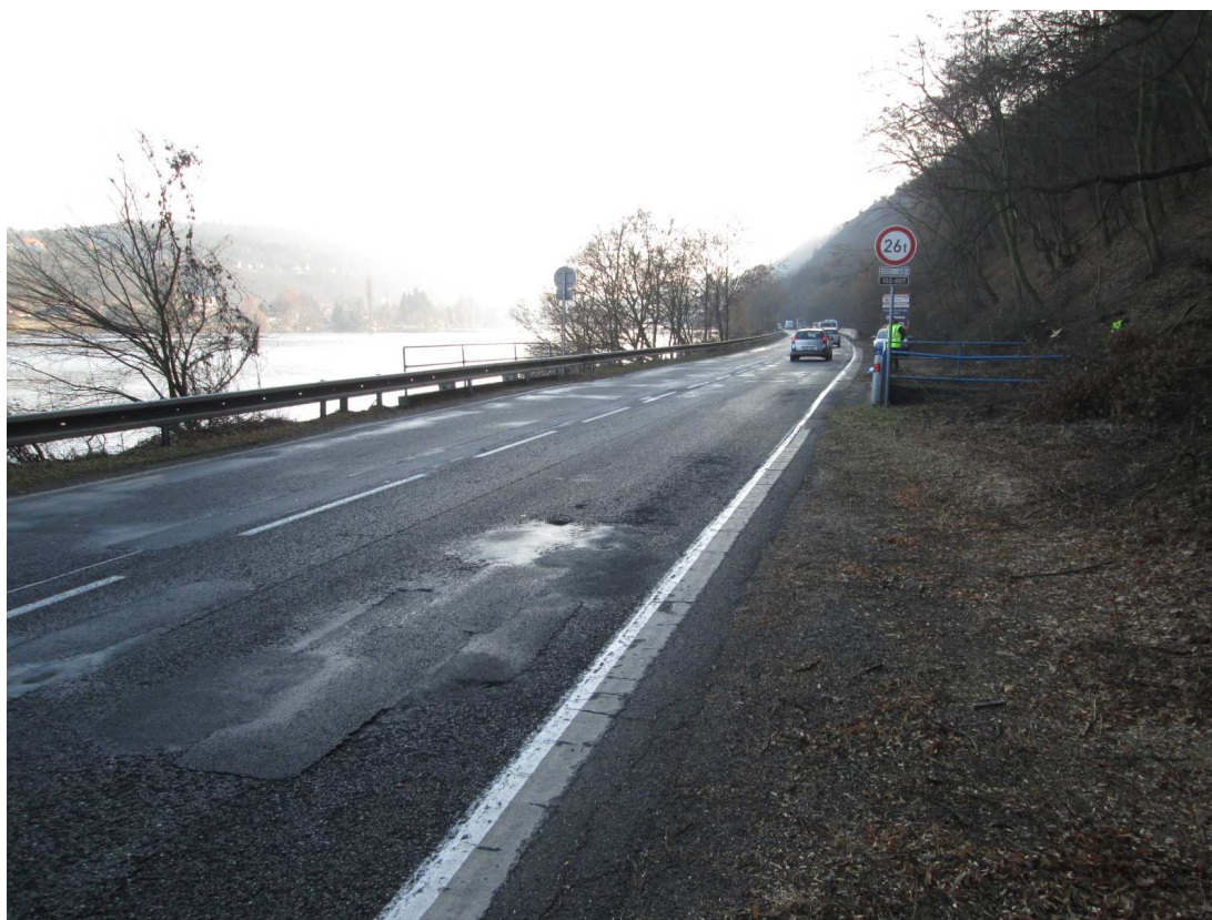
Pohled ve směru staničení. Nevyhovující záchytný systém.
